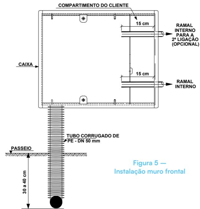
Figura 5 — Instalação muro frontal
