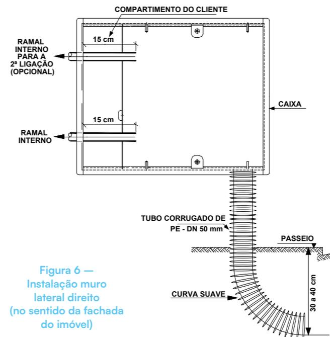
Figura 6 — Instalação muro lateral direito (no sentido da fachada do imóvel)
