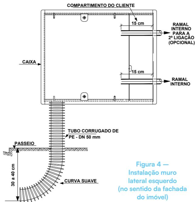
Figura 4 — Instalação muro lateral esquerdo (no sentido da fachada do imóvel)
