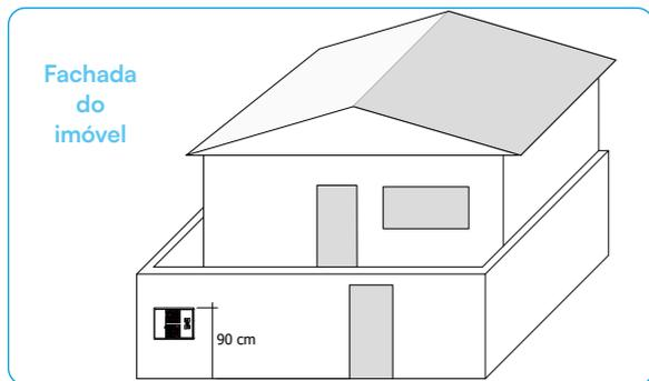
Figura 1 — Instalação na fachada do imóvel
